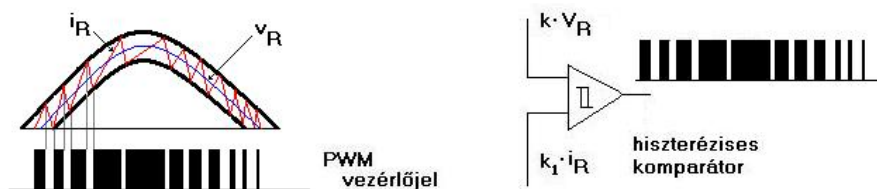
18.55. ábra. Az egyfázisú, kétállásos (bang-bang) vezérlés alapelve
