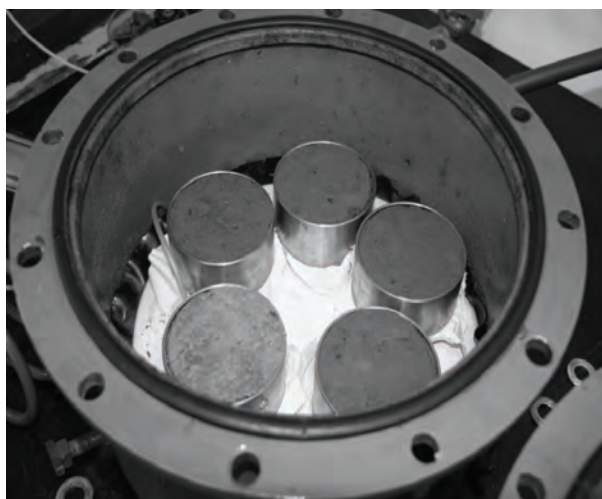
1. ábra. A pF-értékek meghatározására szolgáló porózus kerámialapos extraktor (Soilmoisture Equip. Corp.)
