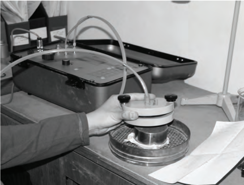
2. ábra. Légáteresztő képesség mérésére szolgáló PL-300-as típusú permeaméter (UGT)
