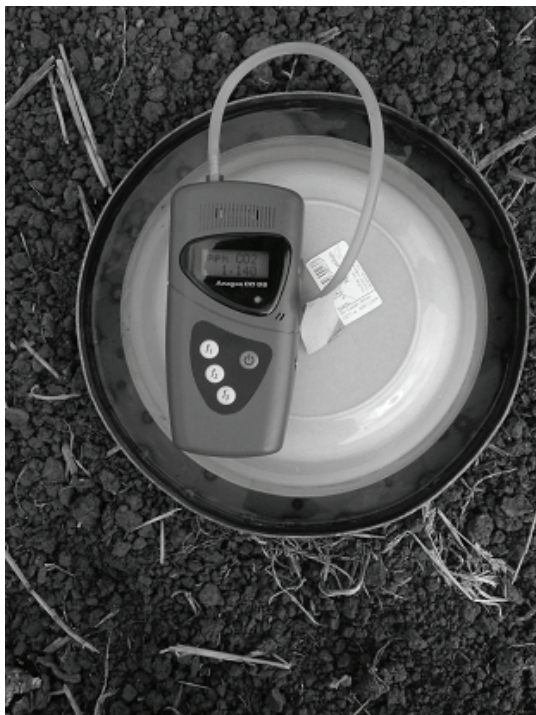
3. ábra. Az ANAGAS CD 98 típusú infravörös gázanalizátor
